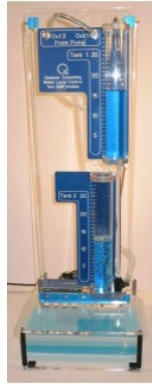
Figura 3. Sistema de tanques acoplados
