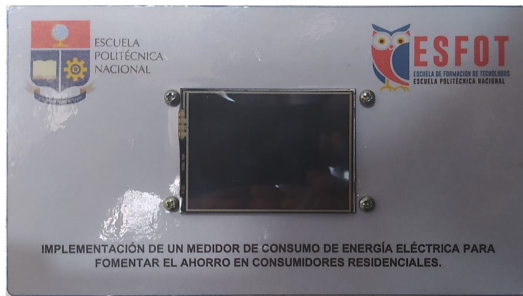
Figura 9. Medidor didáctico de consumo de energía residencial
