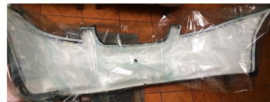
Figura 15. Bolsa de vacío utilizada para el proceso VARTM
