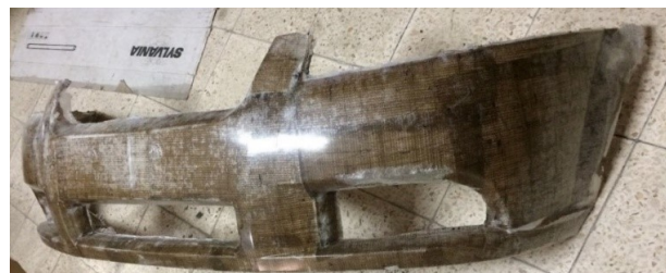
Figura 19. Vista lateral del prototipo de guardachoque obtenido mediante VARTM
