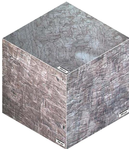
**Figura 4.** Ensamblaje tridimensional de microfotografías ópticas del acero inoxidable 316L procesado mediante LPBF
