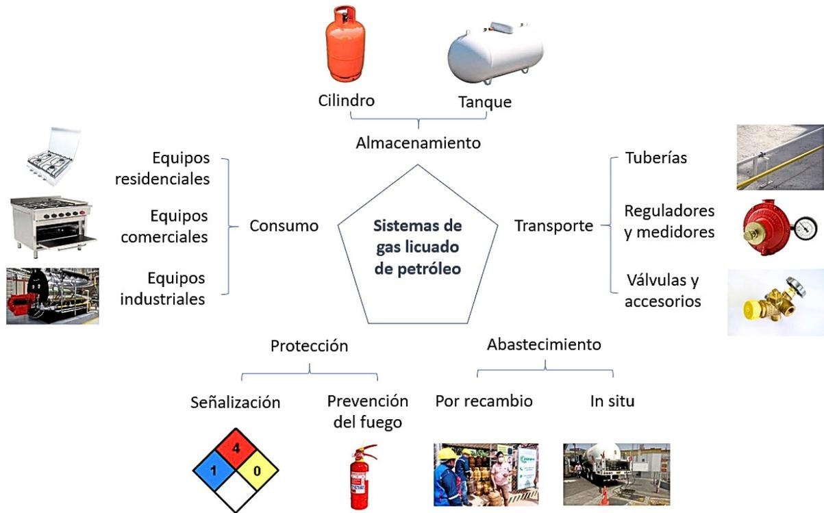
Figura 1. Esquema general de un sistema de GLP [31]
