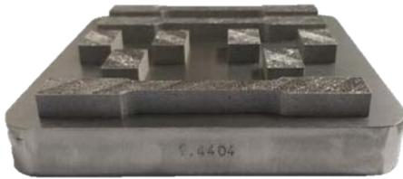
**Figura 2.** Muestras fabricadas de forma aditiva para la evaluación de la microestructura y las propiedades mecánicas. Dimensiones de la placa base:  $100 \times 100 \times 16$  mm
