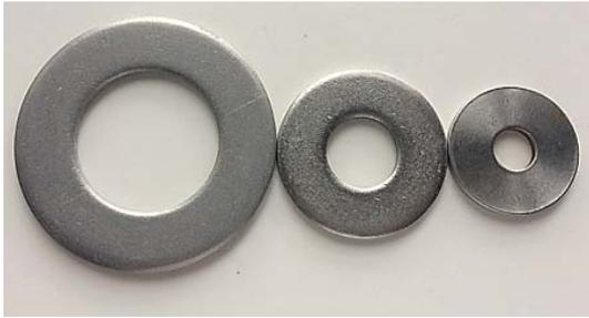
**Figura 5.** Material moliente – Arandelas de acero inoxidable
