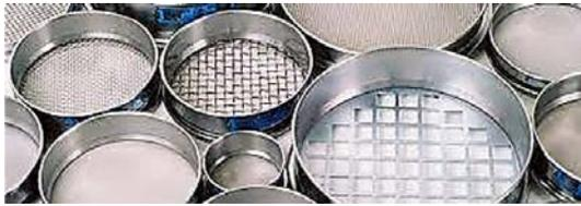
**Figura 2.** Tamiz y proceso de tamizado
