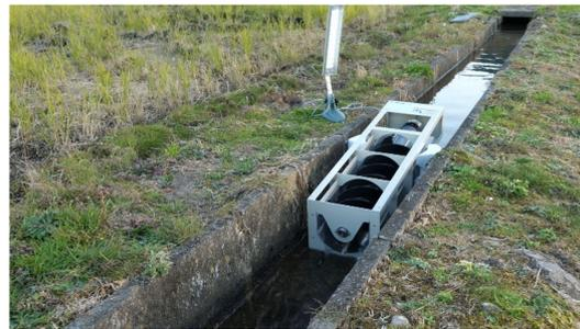
**Figura 11.** Sistema de microgeneración hidráulica instalado en riachuelo
