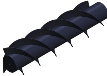
**Figura 3.** Microturbina hidráulica tipo tornillo de Arquímedes
