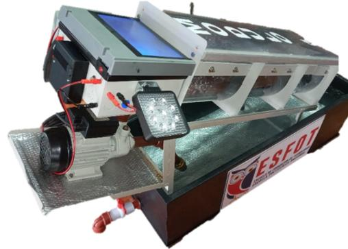
**Figura 10.** Sistema de microgeneración hidráulica
