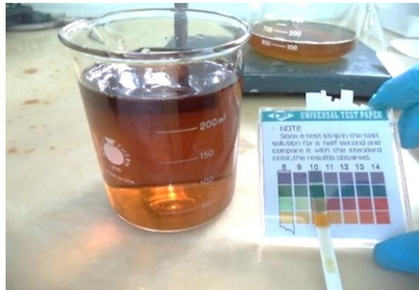
**Figura 2.** Formación del color marrón oscuro de las NPs-Ag
