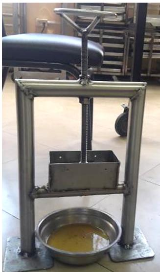
**Figura 1.** Extractora de aceite por prensado manual
