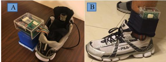
**Figura 6.** A: Tarjeta controladora y baterías montadas en una caja de acrílico. B: Montaje de los dispositivos con una banda de velcro.
